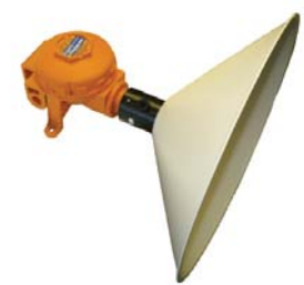
Cono Collettore Per la rivelazione di gas più leggeri dell'aria come l'idrogeno
